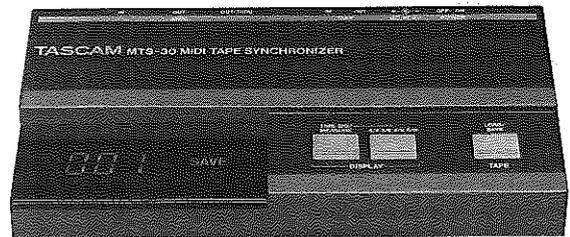
Der MTS-30 ermöglicht die Synchronisation des 238 Syncaset mit MIDI-Keyboard, Drum Machine- und Sequenzer-Geräten. Die überlegene Synchronisationsstabilität der MIDI-Geräte garantiert einwandfreien Betrieb auch bei Bandumspulungen innerhalb eines Aufnahmeabschnitts. Der MTS-30 kann vom PITCH CONT-Regler des 238 Syncaset gesteuert werden. Die optimale Synchronisationsstabilität wird durch einen neuentwickelten Fehlerkorrekturschaltkreis erzielt.
